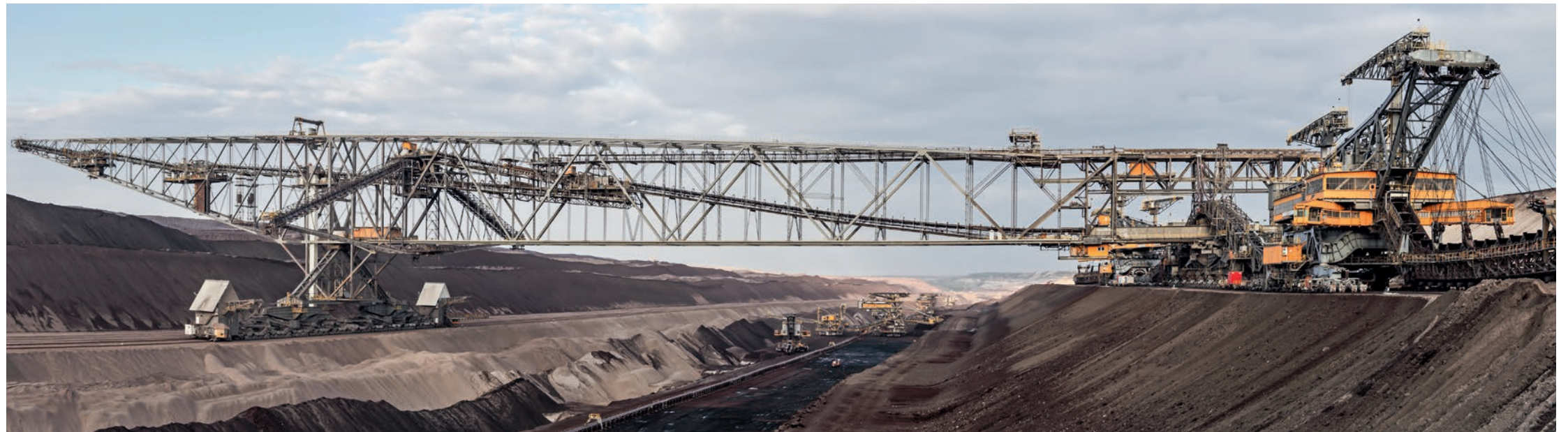
Транспортно-отвальный мост для добычи бурого угля открытым способом
