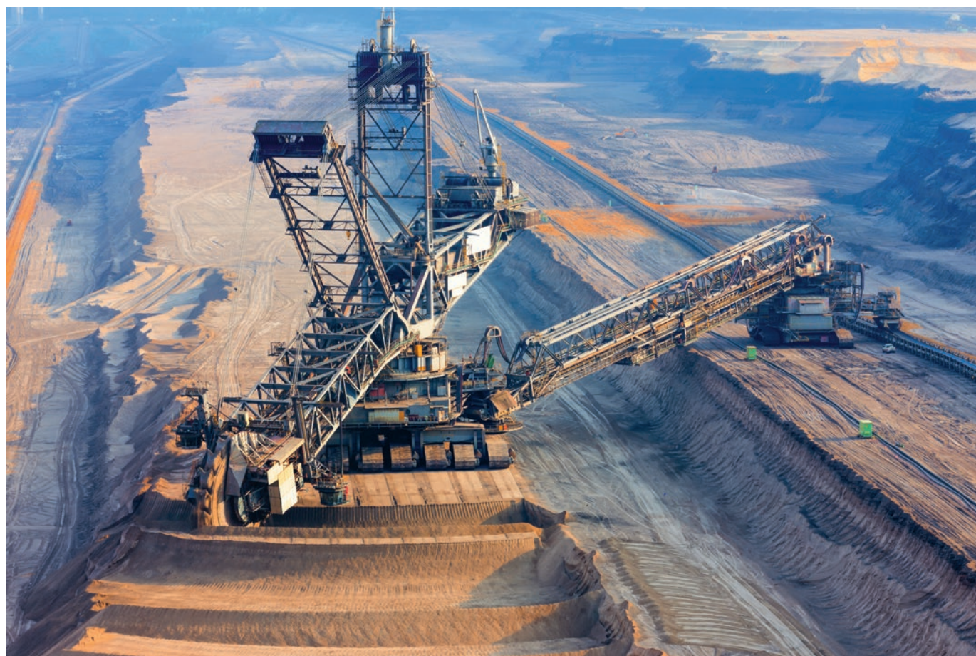
Роторный ковшовый экскаватор на угольном разрезе
