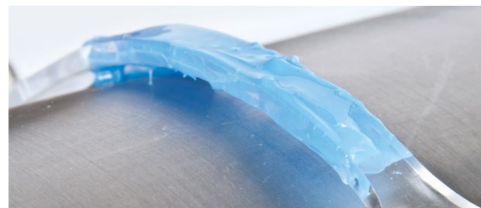
Испытательный образец в испытании изогнутой полосы согласно EN ISO 22088-3 без смазочного материала и с этим материалом.
