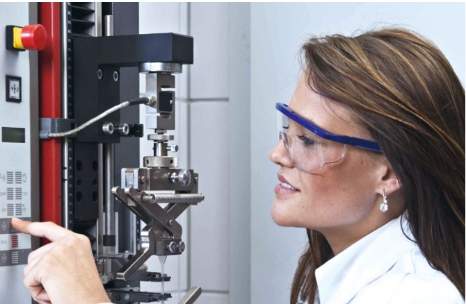
Разрывная машина для испытаний на прочность эластомеров и пластмасс по отношению к продукции BECNEM
