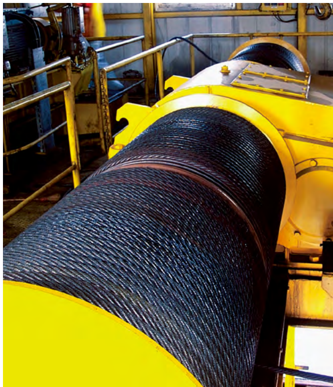
Канатная жидкость Beruprotect Rope Spray очень хорошо подходит для пыльной внешней среды, поскольку он образует гладкую поверхность, которая препятствует налипанию грязи.
